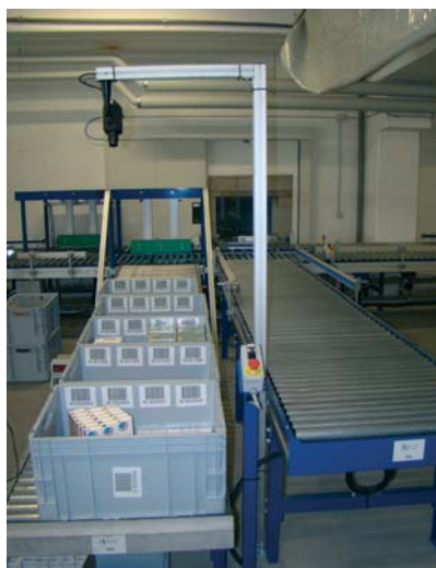
Le operazioni di prelievo sono organizzate in ondate di ordini suddivisi per canale - grossisti, ospedali e prodotto pubblico. Circa il 50% del volume di picking riguarda colli interi, il 30% colli misti e circa il 20% pallet interi: ogni riga d'ordine viene così scomposta nelle differenti attività di picking
